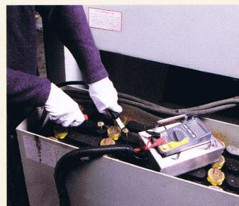
DC-60Bによる電動式フォーク用バッテリーの電圧測定
