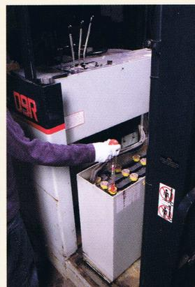
比重計による電動式フォーク用バッテリーの比重測定
